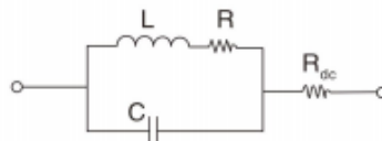
片式电感器的等效电路
